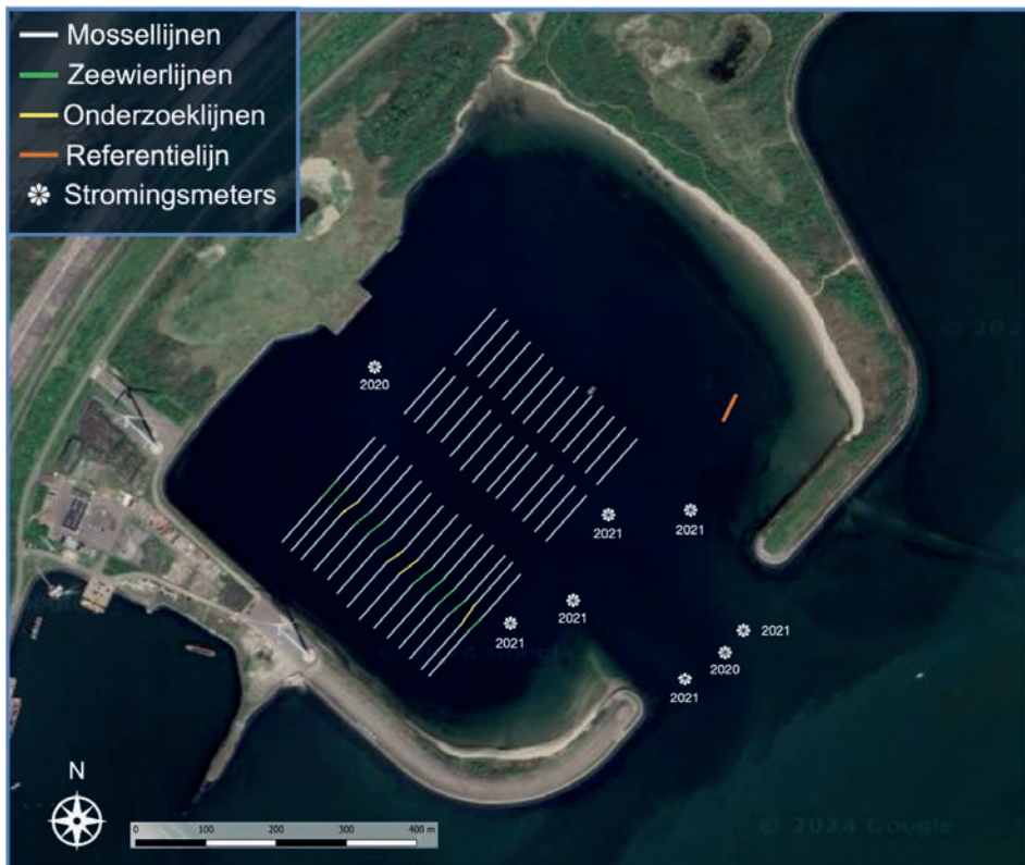
Figuur 3. Detail van de productielocatie Mattenhaven met de ligging van de stromingsmeters en de mossel- en zeewierlijnen (inclusief referentielijn).
