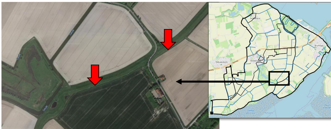
Figuur 6, Aanbevolen meetlocaties om het huidige doorstroomprofiel van de secundaire watergangen in kaart te brengen
