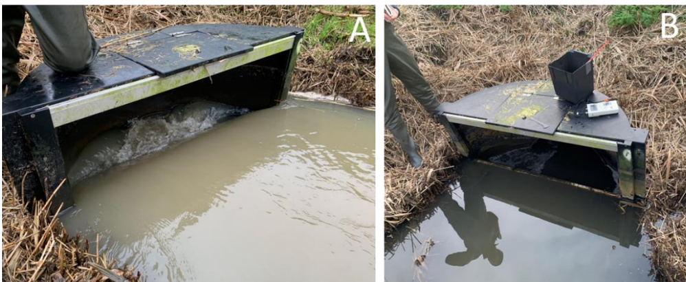
Figuur 1. Piekafvoer op 12 januari 2023, 80.9 L/s (A) en basisafvoer op 13 februari 2023, 13.8 L/s (B) bij de stuw aan de westkant van de Meeldijk, ter hoogte van Meeldijk 14.
