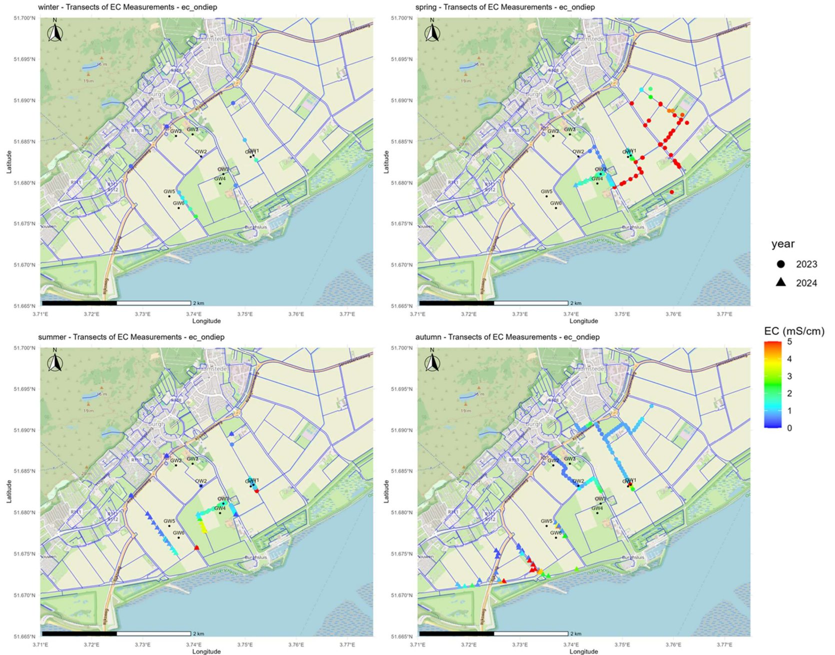
Figuur 6: De EC-metingen (geleidbaarheid, mS/cm) die in 2023 en 2024 in het projectgebied zijn uitgevoerd zijn weergegeven in dit figuur. De metingen zijn onderverdeeld in vier seizoenen, daarnaast is onderscheid gemaakt tussen de metingen die in 2023 (cirkels) en 2024 (driehoeken) zijn gedaan. De metingen die in dit figuur zijn weergegeven zijn allemaal ondiep in de watergang uitgevoerd (<20cm onder slootpeil).
