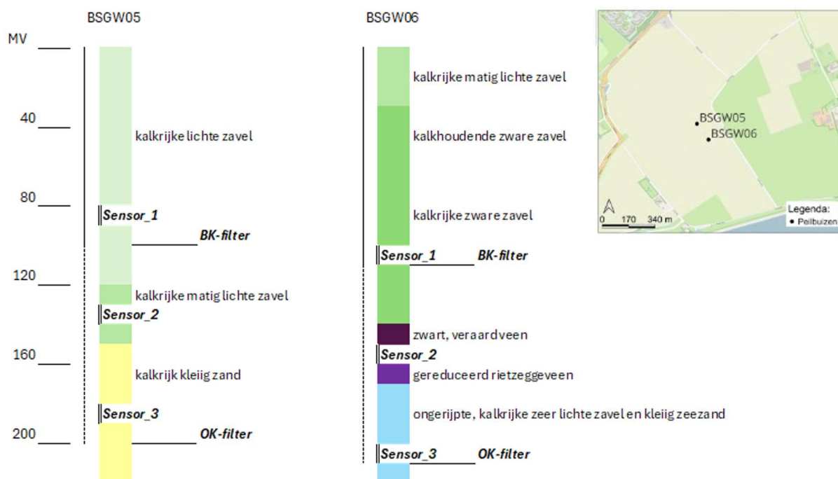
Figuur 3: Bodemopbouw bij de twee peilbuizen die voor pilot 4 zijn geplaatst.
