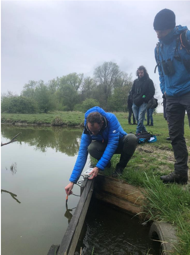
Afbeelding 3. Metingen aan het zoutgehalte van het oppervlaktewater in fieldlab Dijkwater (foto Buro Waterfront)
