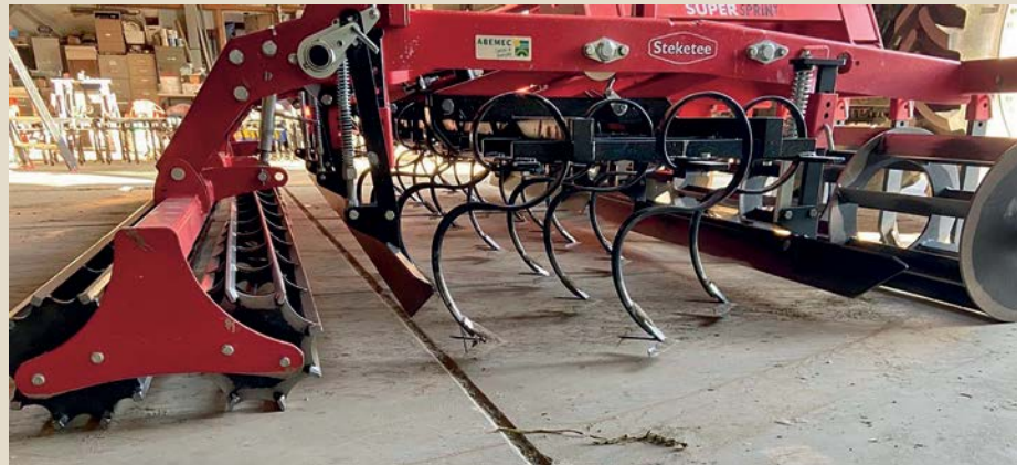
De aangepaste Steketee snel-eg.
