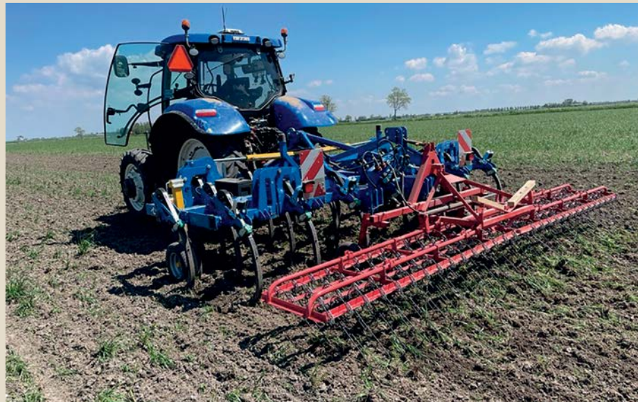
De Treffler-cultivator met zelfgemaakte eg.
